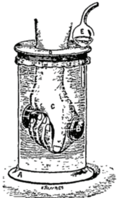
دستگاهی که لومبروسو برای اندازه‌گیری فشارخون اختراع کرده بود.
