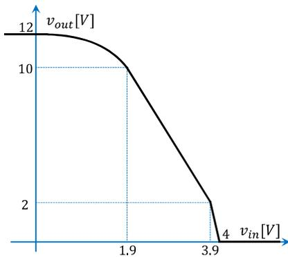
۳- مشخصه‌ی انتقالی تقویت کننده‌ی ولتاژ A، (با مقاومت ورودی خیلی بزرگ و مقاومت خروجی صفر) به شکل روبروست و در مداری مطابق شکل زیر استفاده می‌شود. (خازن‌ها به اندازه کافی بزرگند)
