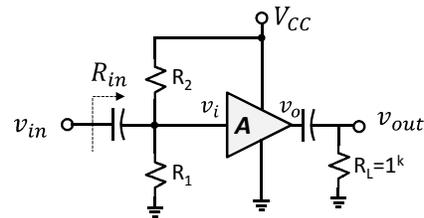
( $V_B$ ) ولتاژ DC ورودی تقویت کننده، توسط مقاومت‌های  $R_1$  و  $R_2$  تعیین می‌شود.
