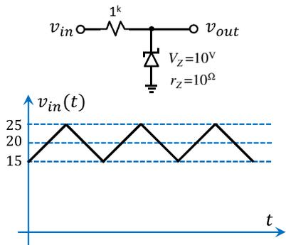
(\*) ۲- ولتاژ ورودی مدار شکل روبرو، به شکل زیر می‌باشد.  $v_o$  را بدست آورید. متوسط توان تلف شده در دیود زبر و مقاومت  $1k$  چقدر است؟
