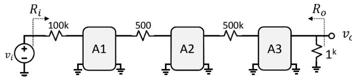
$$A1 \begin{cases} R_i = 500^k \Omega \\ R_o = 10^k \Omega \\ G_m = 10^{mA/V} \end{cases} \quad A2 \begin{cases} R_i = 1^k \Omega \\ R_o = 100^k \Omega \\ A_{i_o} = 1000 \end{cases} \quad A3 \begin{cases} R_i = 2^M \Omega \\ R_o = 100 \Omega \\ R_m = 10^{kV/A} \end{cases}$$
