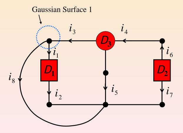
Gaussian Surface 1:  $i_1 - i_3 + i_8 = 0$
